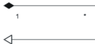
Rys. 1. Połączenia powiązania, kompozycji i generalizacji w notacji UML
